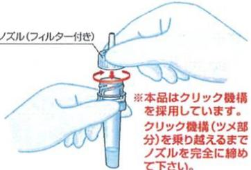
※本品はクリック機構を採用しています。クリック機構(ツメ部分)を乗り越えるまでノズルを完全に締めて下さい。
